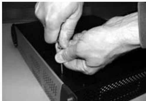
Retrait des vis du panneau supérieur
