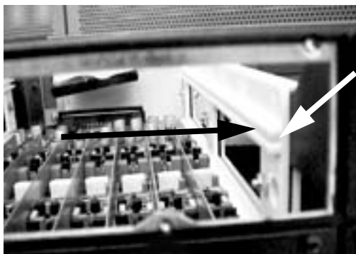
Exemple de baie vide. Remarquez la présence des rails permettant de guider la carte sur la face latérale interne
