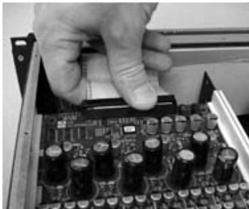
Connexion du connecteur du câble à 50 broches à la carte
